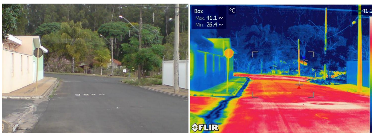
Figura 1. Imagem fotográfica comum (esquerda) e termal (direita) de via pública ao meio dia na cidade de Rio Claro, SP. A barra de temperatura na direita mostra valores em graus Celsius. Fonte: (CRESTANA, et al. 2007).
